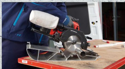
Měď, plast, ocel C, litinu nebo nerezovou ocel lze řezat až do průměru trubky 110 mm
