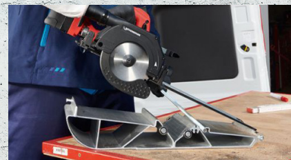
Funkce upnutí umožňuje nejrychlejší řezný výkon pro různé materiály
